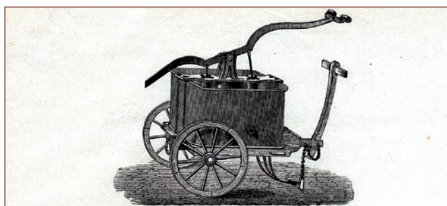
Zweirädrige Druck-Feuerspritze Nr. III von Joseph Beduwe in Aachen.
