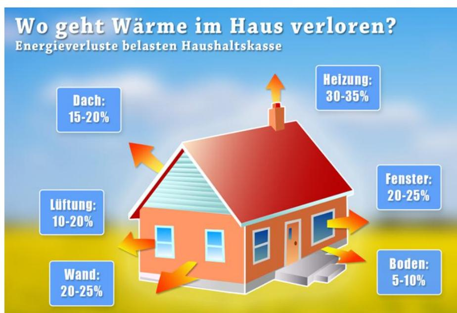
Abbildung 5-1: Energieverluste bei der Wärmeversorgung bestehender Wohngebäude<sup>58</sup>
